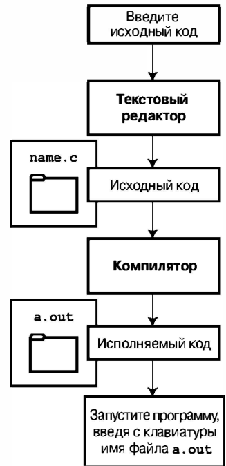
Рис. 1.5. Подготовка программы на языке C в среде операционной системы Unix
